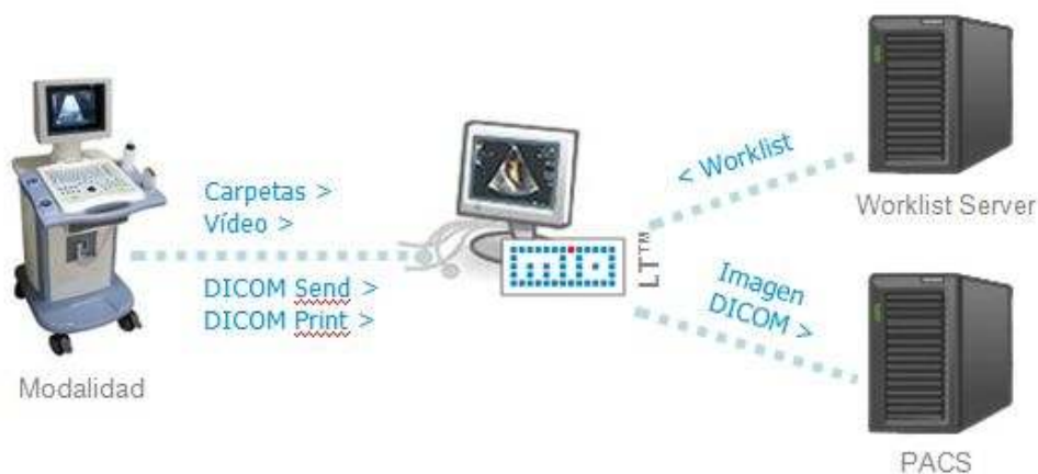
Figura 1.1: Esquema básico de instalación de MIO LT™: captura de imagen, recepción de datos de paciente y envío a PACS
